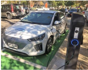
14 puntos de carga eléctrica AC Municipalidad de las Condes Carga AC de 22kW ENEL X y Engie
