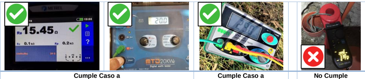
Imagen 50: Medición de la resistencia a tierra.
