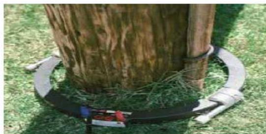
**Figura 7. Transformador de corriente para abrazar todo el poste**
