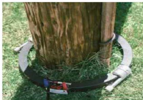
Figura 7. Transformador de corriente para abrazar todo el poste
