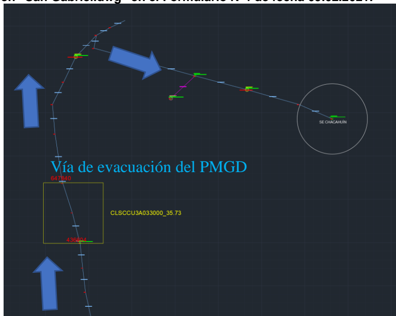
Figura 3: Tramo soterrado existente en Alimentador San Gabriel en vía de evacuación del PMGD Pachira Dos, presentado en "San Gabriel.dwg" en el Formulario N°4 de fecha 09.02.2021.
