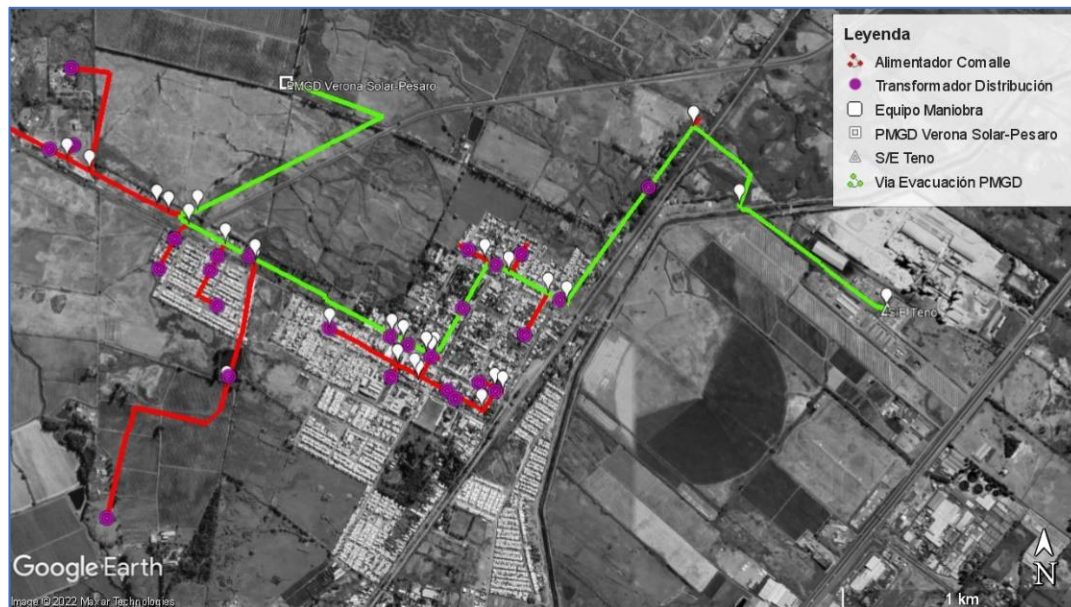
Figura 2: Sección Alimentador Comalle afectado por Obras Adicionales PMGD Verona Solar-Pesaro.
